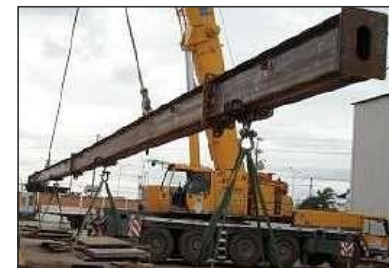
Projeto de spreader bar (balancim) para lançamento submarino de dutos , 42m de compr. e carga de teste de 50t força. Balancins sobre barcaça offshore para transporte até local de operação.
